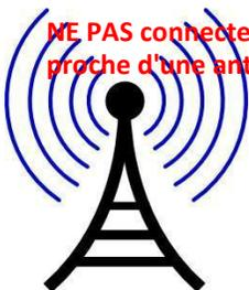
**NE PAS connecter directement un RSP à la même antenne que votre émetteur, ou à une antenne dans le champ proche d'une antenne émettrice, car cela risque d'entraîner des dommages irréversibles à votre RSP.**
