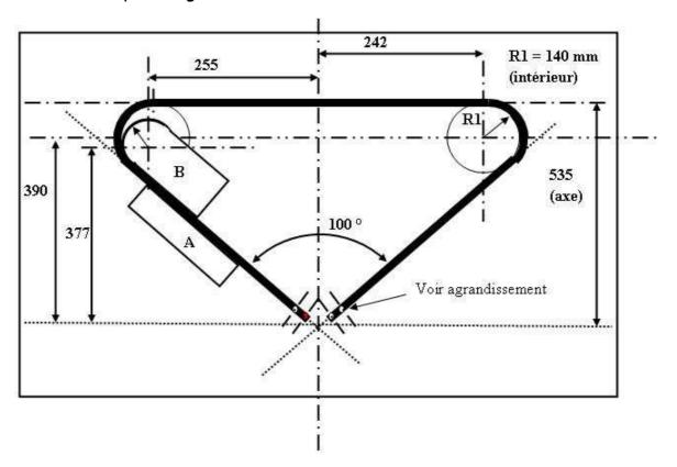
Déplacer le ressort jusqu'à obtention de la courbure tracée pour le tube . Percez le tra de 3 mm au bout de la " demi feuille " obtenue.
