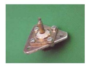
Souder un tube de laiton de diamètre extérieur 4 mm et de 12 mm de long si l'âme de la SO239. Souder à l'autre extrémité une tige filetée de 3 mm é laiton et d'une longueur de 16 mm. L SO239 ainsi modifiée est boulonnée sur triangle de connexion inférieure.
