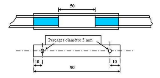
DETAIL DES EXTREMITES DES ELEMENTS (positionnement des connections centrale A dessiner sur le gabarit de cintrage, percer le trou repéré en rouge.
