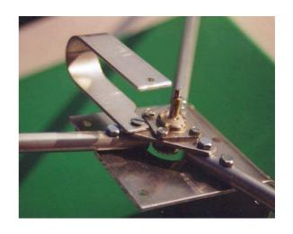
Percer et découper les morceaux de plaques des couches 1 et 2. Attention : la découper le niveau 2 doit être assez grande pour le passage de la base de la 5023 Agrandir le trou central à la râpe conique avant de scier. Si le plastique fond et colle à râpe, laisser refroidir et le bloc solidifié s'enlève alors très facilement (coup sec c tournevis).
