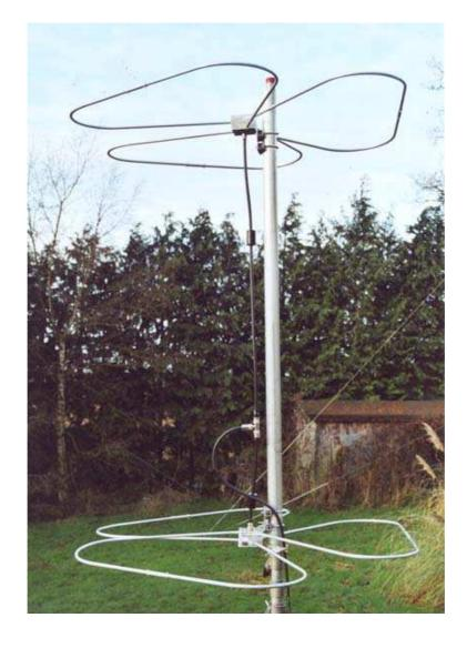
Ceux qui voudront " chasser le DX ", en mettront deux (au moins). Le gain augmente de + dB pour 2 antennes superposées. Mettez un préamplificateur de réception " en tête c mât " pour compenser les pertes du câble de liaison (le gain étant, on l'a dit, relativement modeste, il faut perdre le moins possible des dixièmes de microvolts captés par l'antenne
