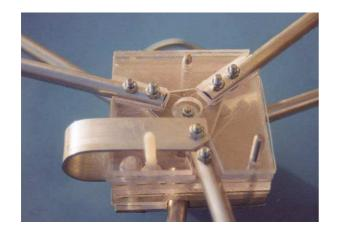
Assembler avec les demi-feuille supérieures. Boulonner le contact centr (mettre une rondelle plate " large " : vo photo ci-dessus).
