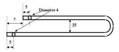
Le « stub » est réalisé à partir d'une bande en aluminium de 20 mm de large et 2 m d'épaisseur. Sa longueur développée est de 127 mm pour une antenne en « espace libre » il doit être d'environ 152 mm pour une antenne au dessus d'un véhicule (à 5/8 de longuei d'onde soit environ 130 cm).
