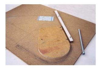
Cintrer chaque tube à l'aide du gabari Poser le tube dans la rainure entre le pièces " A " et " B " du gabarit, enfiler uboulon de 4 mm dans le trou le plus près a bout et dans celui du gabarit (ça bloque tube).
