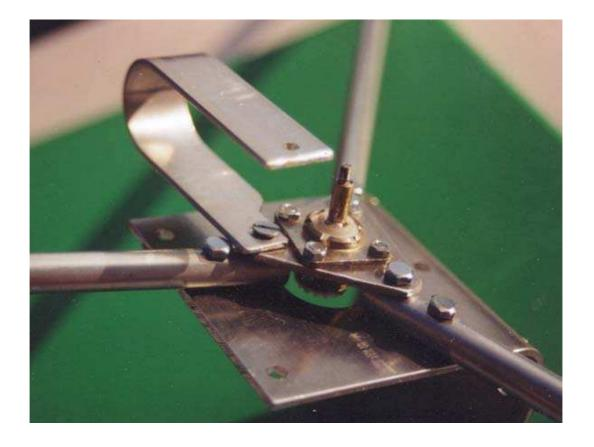
Percer les trous à chaque bout du stub. Fraiser un des trous, de sorte que la tête de la v de fixation ne dépasse pas au montage.
