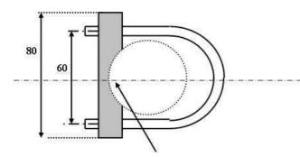
La longueur développée de la tige filetée d diamètre 5 mm est de 200 mm
