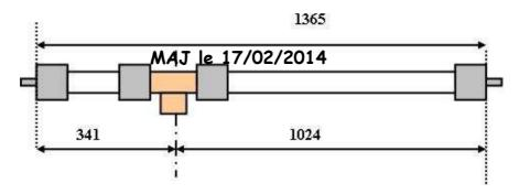
Le montage est facile à faire , la mise en parallèle des deux câbles de 75 ohms se faisai sur les deux branches d'un raccord en " T " pour PL259 et le câble de descente 50 ohn est à brancher sur la sortie milieu .
